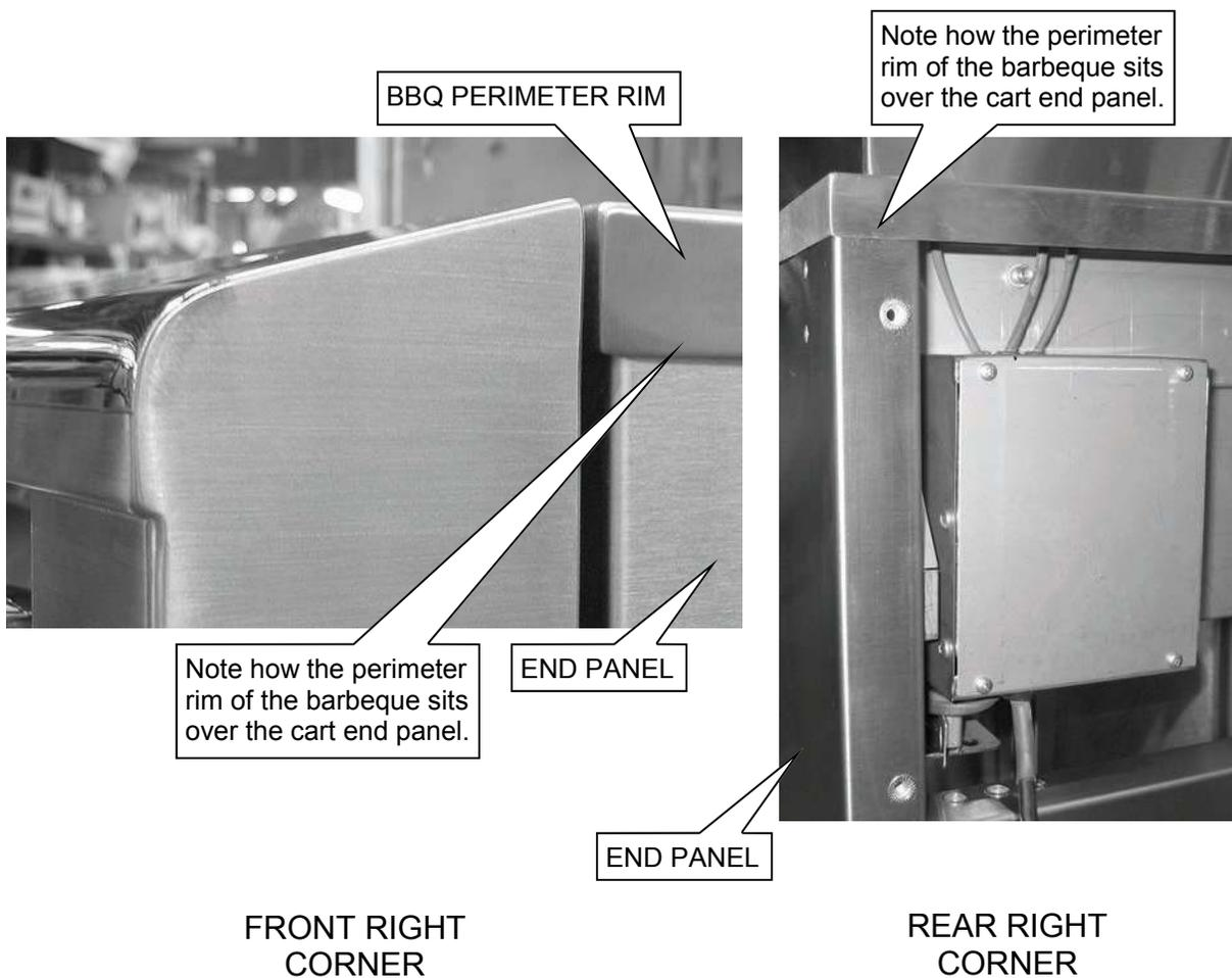
**THE FOLLOWING PROCEDURE SECURES THE REAR OF THE BARBEQUE TO THE CART.**
